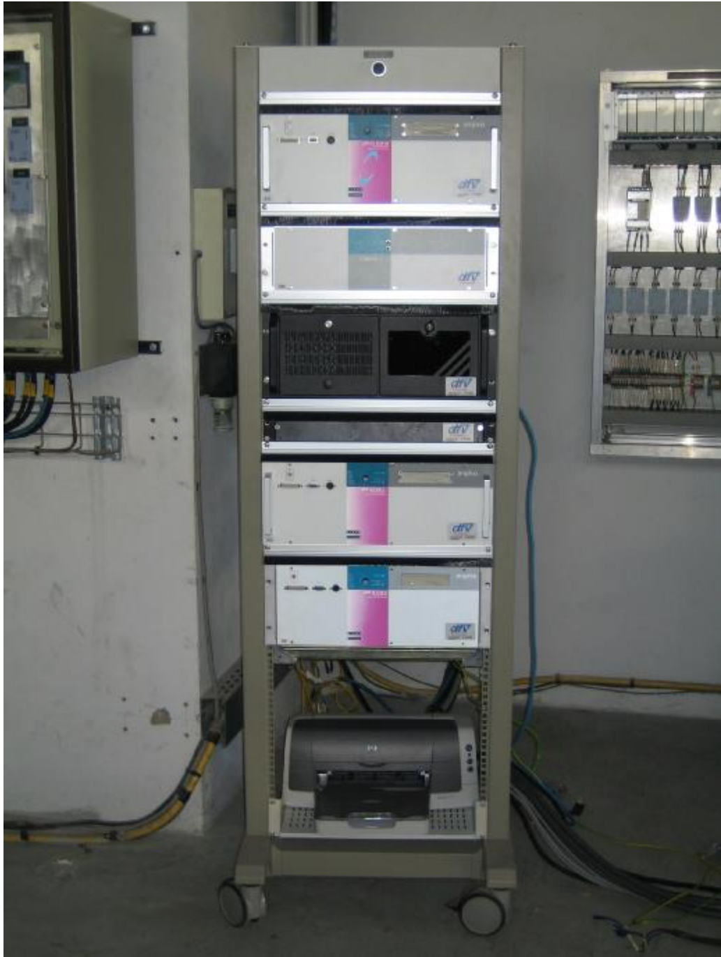
Chassis mobile contenant 3 perturbographes APR16 et un PC d'analyse local. Les mesures sont connectées sur des boîtiers BFOP via fibre optique.
